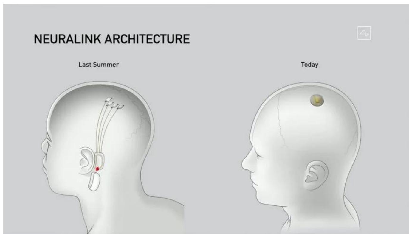
Neuralink 設計出的晶片僅約硬幣大小，該設備稱為 N1，可以用來讀取大腦訊號，透過手術機器人將晶片植入大腦皮層表面。
